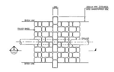
PLAN - TYPICAL DITCH PLUG DETAIL
