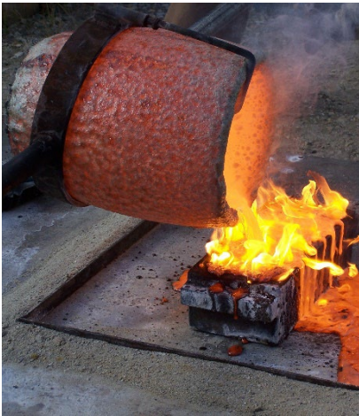
Coulage d'un lingot d'or.
